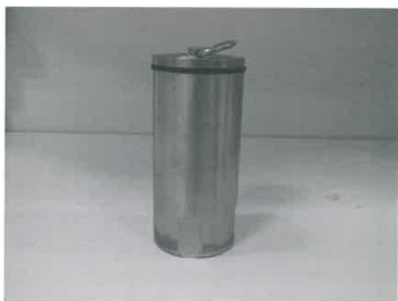
Рисунок 2 – пенал из нержавеющей стали (1 – ручка, 2 – прокладка, 3 – крышка пенала, 4 – корпус пенала)
