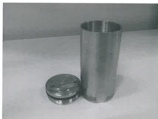
Рисунок 2 – пенал из нержавеющей стали (1 – ручка, 2 – прокладка, 3 – крышка пенала, 4 – корпус пенала)
