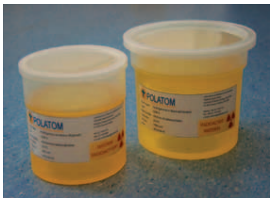
Objętościowe źródła multigamma w żywicy epoksydowej
