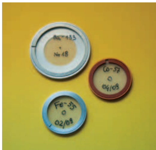
Źródło punktowe \gamma na folii polietylenowej.
